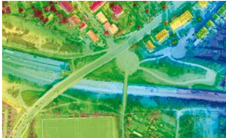
Ausschnitt Frankfurt-Seckbach/A 661: Die Farben der Punktwolke geben die Höhenverhältnisse wieder.
